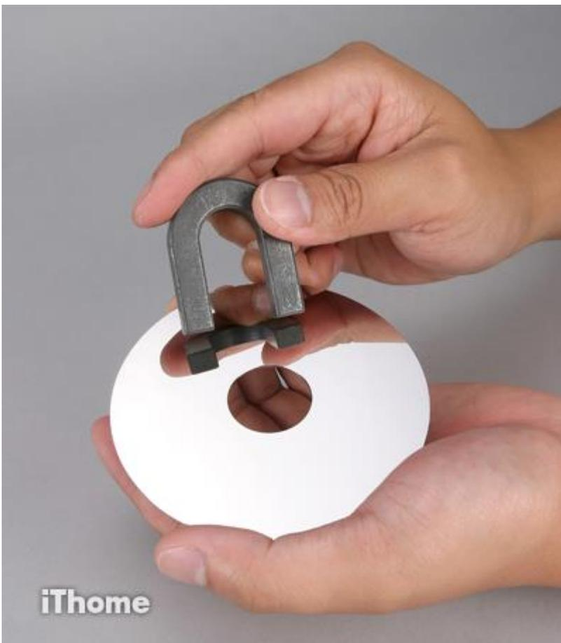
直接把碟片拆下來，用強力磁鐵以不同角度對著碟片做消磁的動作，也是可行的。不過這個方法太麻煩，而且要確保每一個區域都要消磁到，也有太多可能會疏漏的地方。
