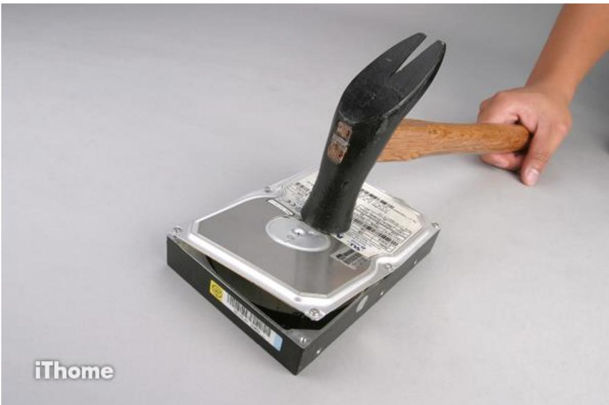
如果直接用鐵鎚用力敲打硬碟的外殼，其實也會造成內部磁頭刮傷碟片，造成硬碟一定程度的損害。
