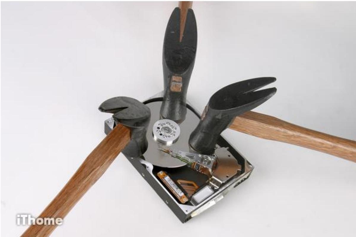
打開硬碟上蓋，用鐵鎚在碟片不同的地方輕輕敲一下，就會打歪了磁頭與碟片的定位，造成硬碟損壞無法讀取。不過若想徹底銷毀碟片上的資料，這樣做的還不夠完整。
